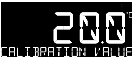
Abb. 41: Temperaturwert des Badtemperaturfühlers
